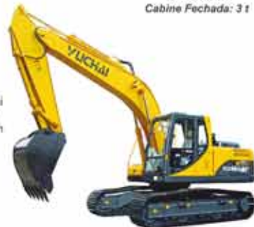
Yc25-8 Peso: 2,8 t Motor: Cummins 30,55hp/2.200rpm Caçamba: 517mm Volume: 0,07m 3 *Em versão Cabine Fechada: 3 t
