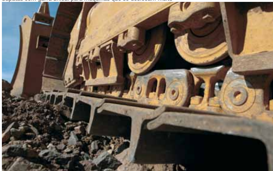
Sapatas com garra única: para máquinas que se deslocam muito
