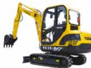
Yc35-8 Peso: 3,7 t Motor: Kubota 42hp/2.200rpm Caçamba: 630mm Volume: 0,12m 3
