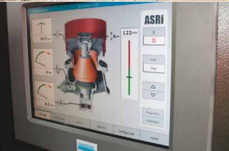
Sistema de controle inteligente com menus de fácil compreensão em português
