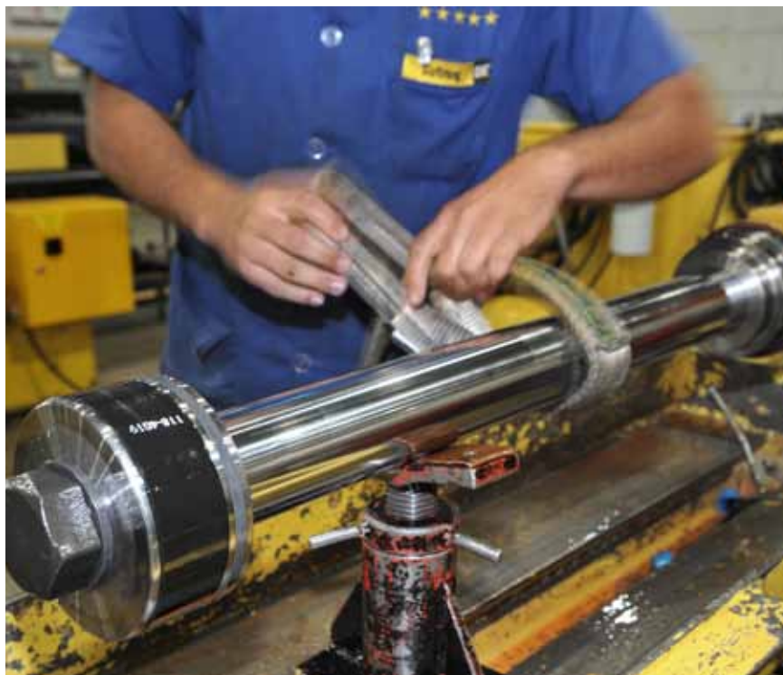
Componentes específicos como cilindros hidráulicos necessitam de manutenção especializadas
