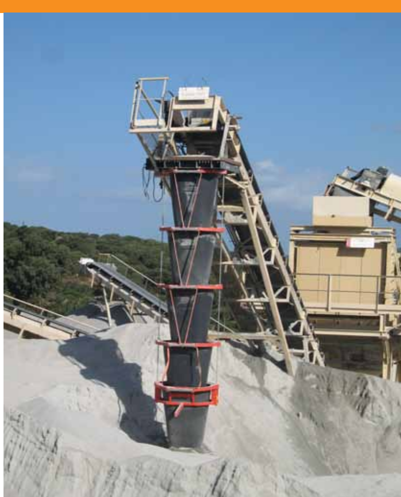
Sistemas de abatimento de poeira eliminam até 99% da poluição na pedreira
