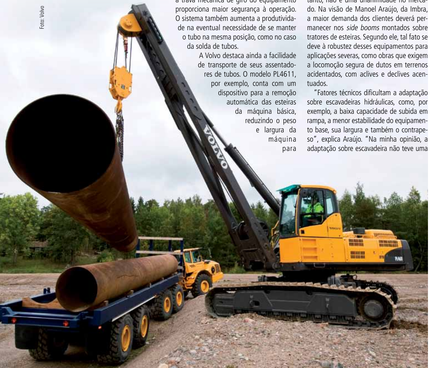
Pipelayer sobre escavadeira: ideal para movimentações em pátio
