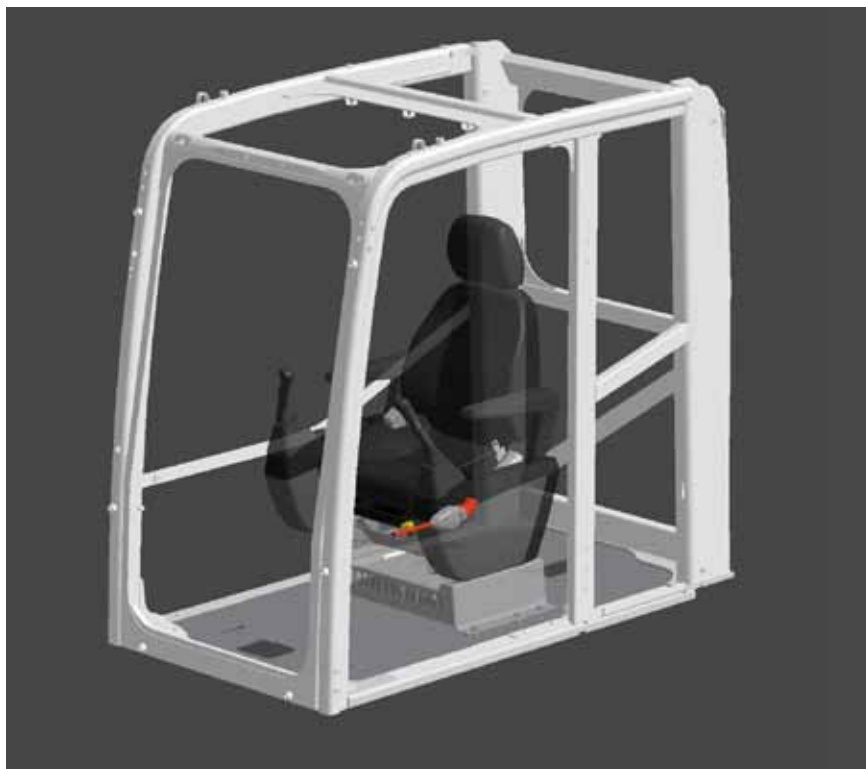
Estrutura das cabines é projetada para resistir a tombamentos e queda de pedras
