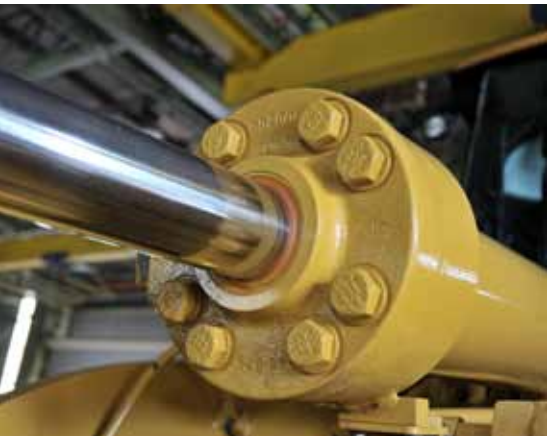
Estanqueidade do sistema evita contaminação do lubrificante
