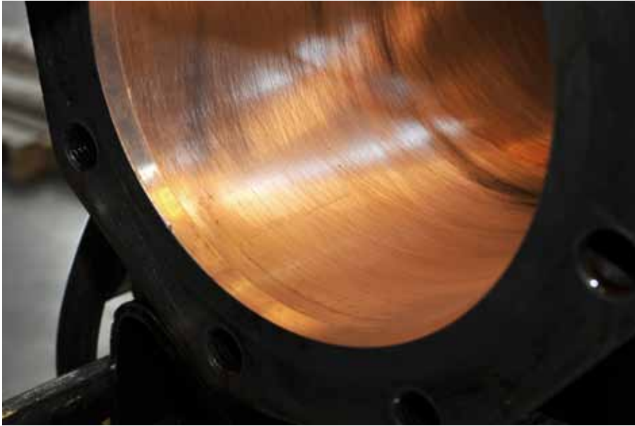
Brunimento da camisa: melhor retenção do lubrificante
