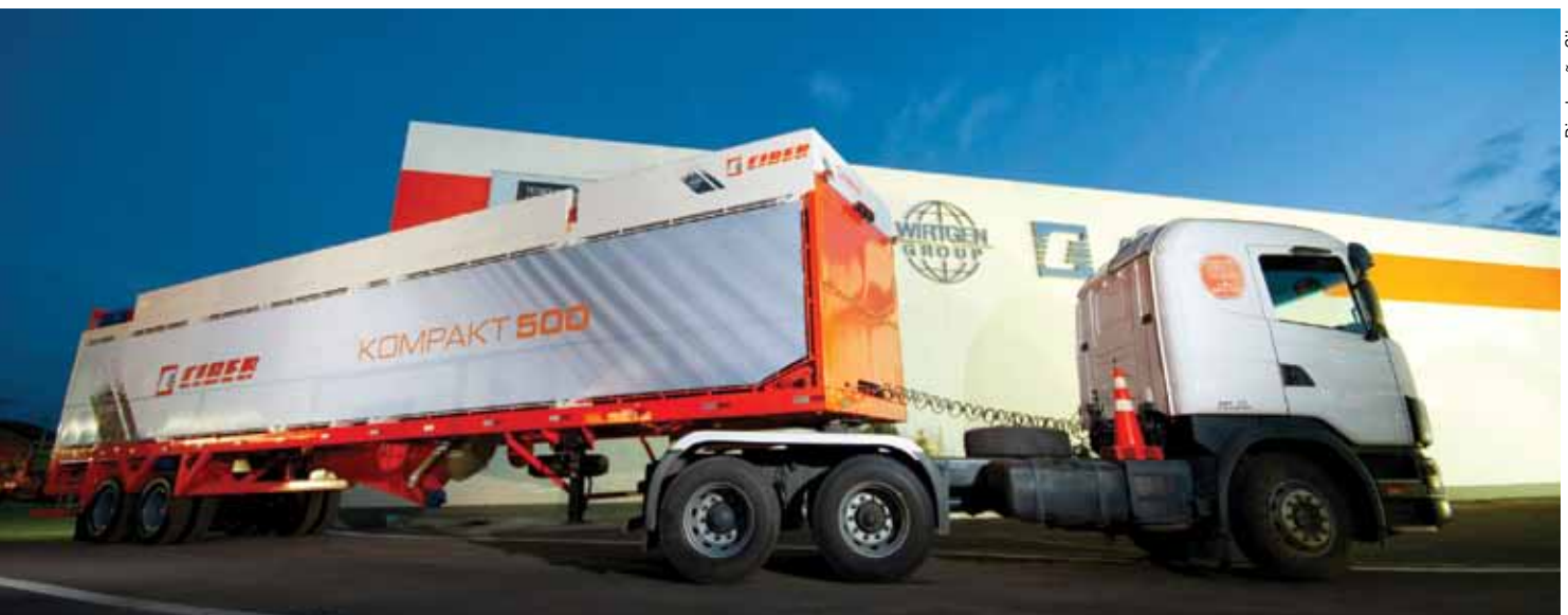
Usinas de asfalto Kompakt 500, da Ciber, produzem de 80 a 150 toneladas
