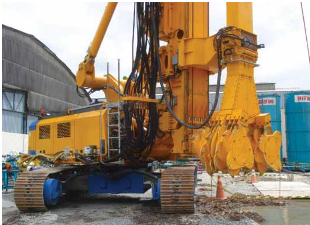
Deep Mixing realiza mistura de solos em profundidade de até 35 metros
