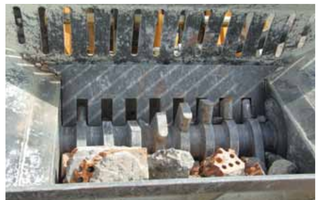
Concha tritura o material por sistema de eixo dentado
