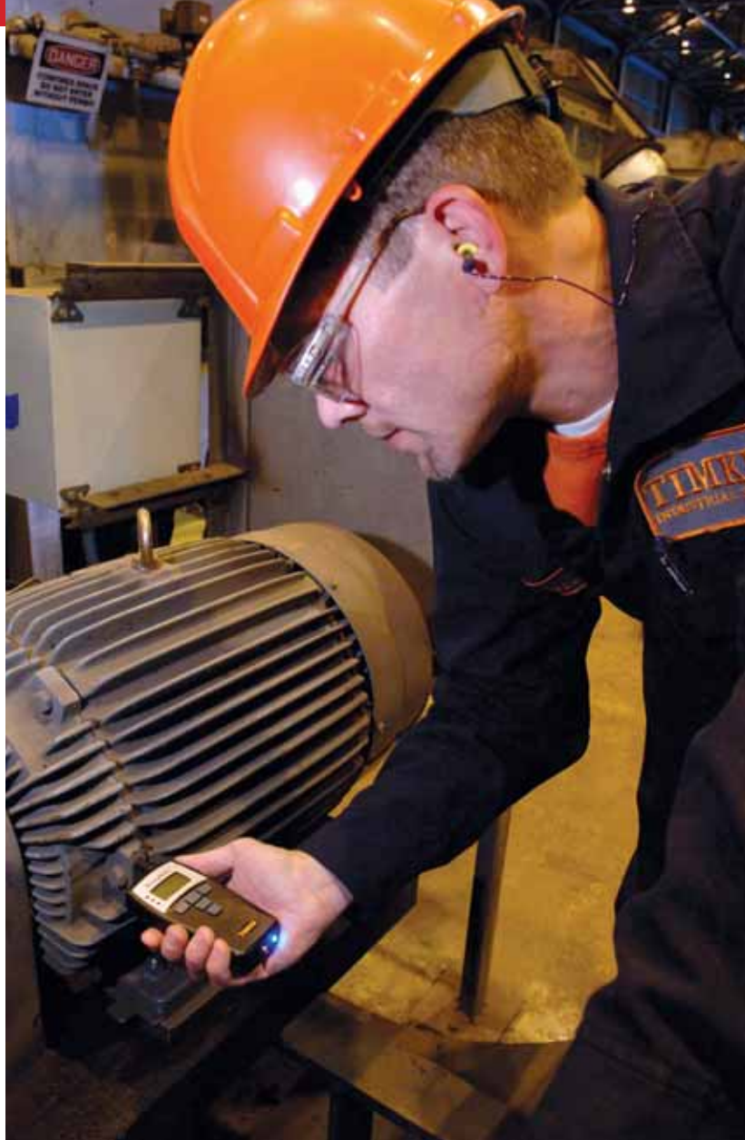
Instrumentos permitem acompanhar variações na temperatura e vibração dos rolamentos
