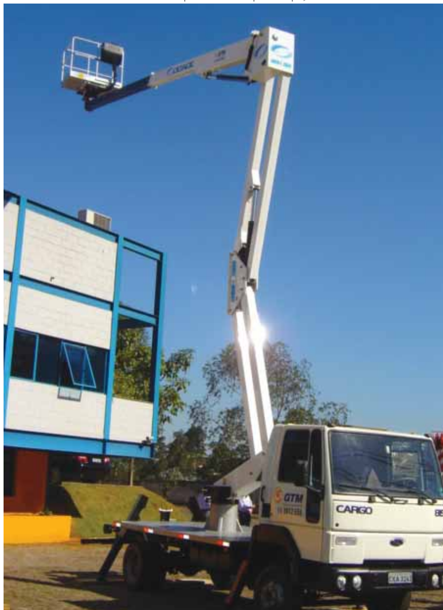
Plataforma aérea sobre chassis de veículo: para obras com pouco espaço
