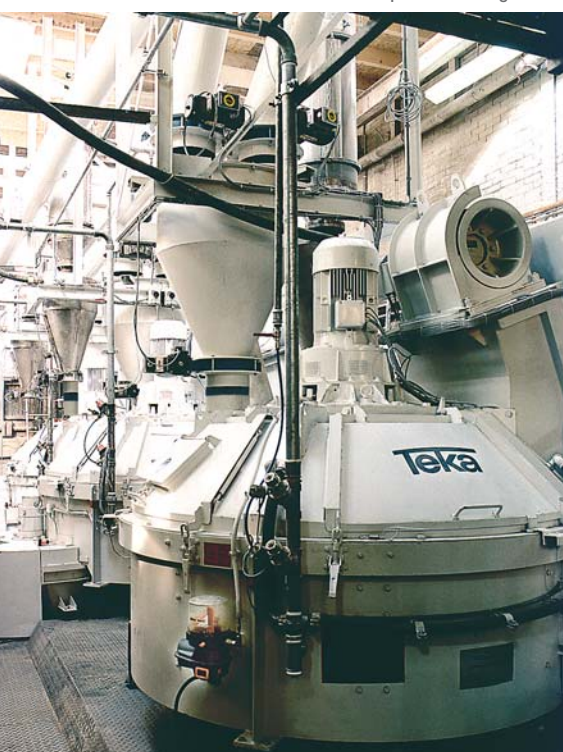
Misturador turbo: menor tempo de descarga
