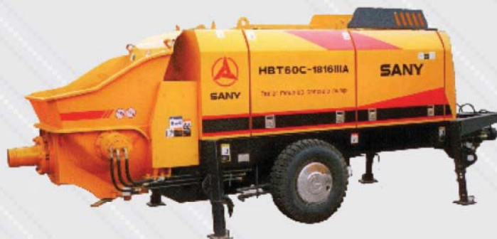
Bomba de Concreto
