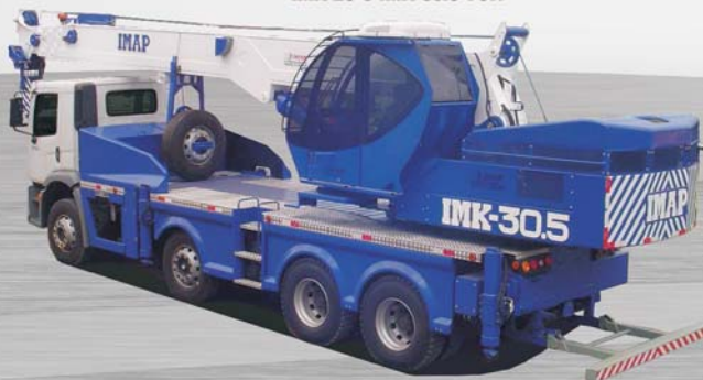
Guindastes a cabo IMK 25 e IMK 30.5 TON
