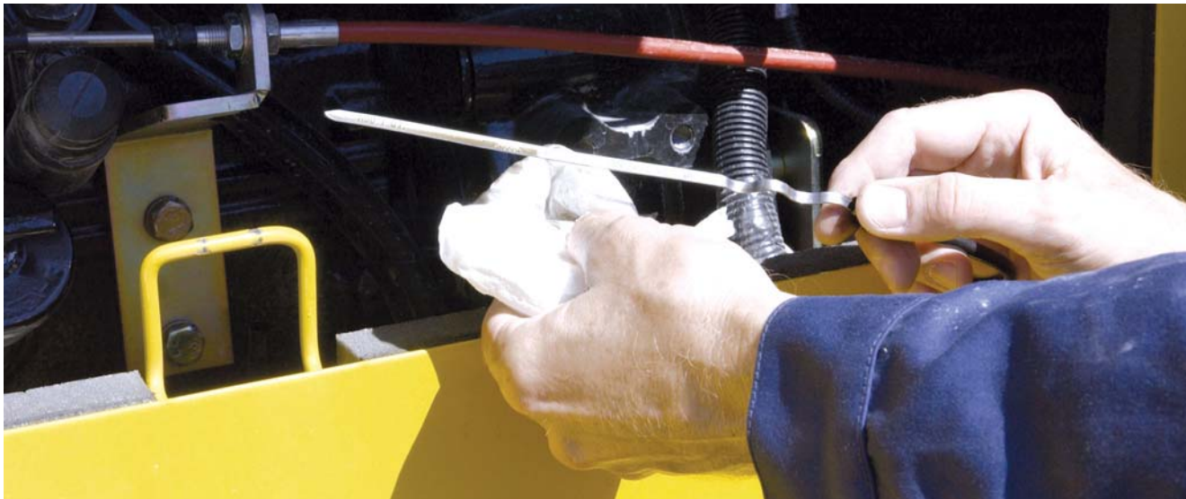
Inspeção da lubrificação: processo não pode ser invasivo
