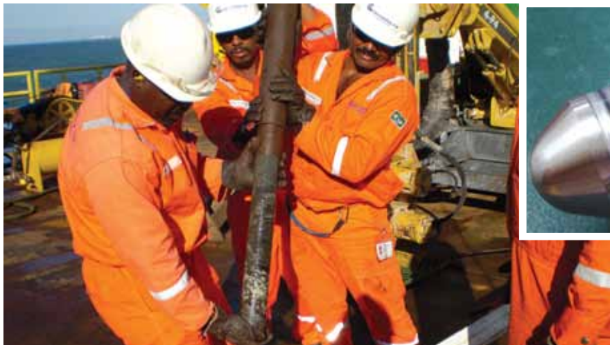
Sonda capta a imagem (destaque) e elimina a necessidade de recuperar o testemunho (acima)
